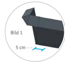
Das Profil (1) wird mit dem ECKELEMENT (2) zusammengefügt, indem sie das Profil (1) an die Außenseite des ECKELEMENTS (2) für ca. 5 cm einstecken (Bild 1).
